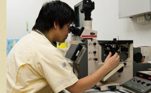
电镀厚度和质量的显微镜检测
