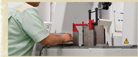
采用精密的 3D 测量检测零部件制造的精度
