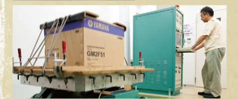
振动测试确保在全球范围内的运输和递送时任何损害都不会发生
