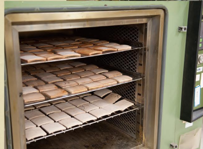
鼓腔的一部分被蒸和烘干以此来测试鼓腔木层的粘合性。
