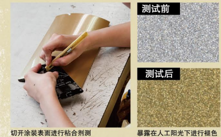
切开涂装表面进行粘合剂测试
